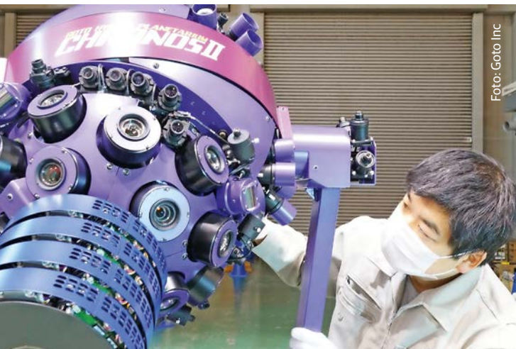
Ein Mitarbeiter des japanischen Herstellers Goto Inc. justiert den Sternprojektor.
